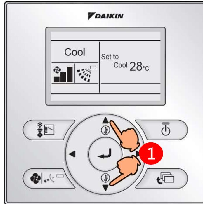
1. 在螢幕背光亮起時按下溫度【▲、▼】鈕,操作空調設定溫度.
